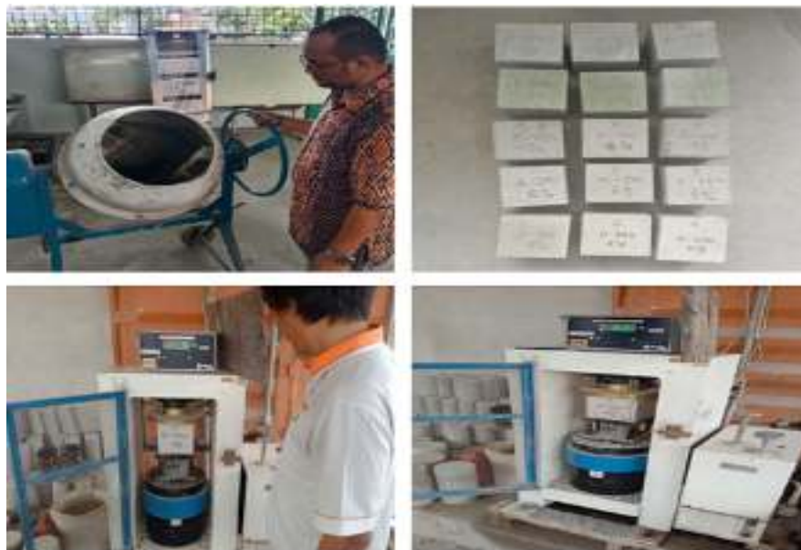
Gambar 3. Proses pembuatan dan pengujian sampel beton
