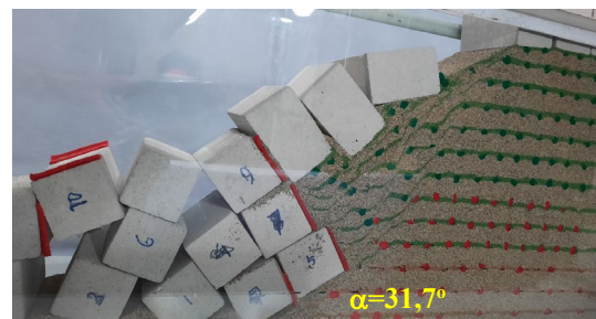
Gambar 15. Pola kelongsoran tanah pasir pada tipe pasir 1 ( \phi=31,7^\circ ), SRW2
