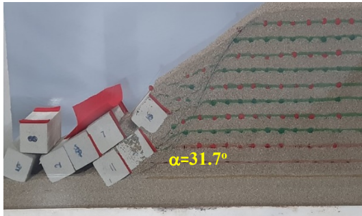
Gambar 20. Pola kelongsoran tanah pasir pada tipe pasir 1 ( \phi=31,7^\circ ), SRW4
