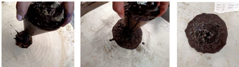
Gambar 2. Proses pengujian konsistensi
