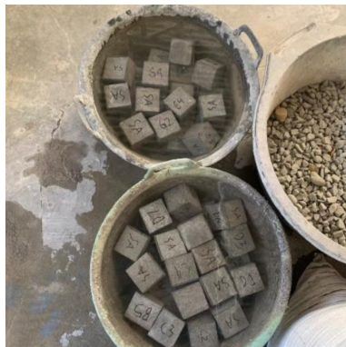
(b) Perendaman untuk keperluan pengujian penyerapan air
