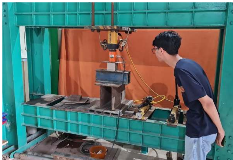
Gambar 5. Pengujian kuat tekan mortar ringan
