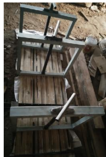
Gambar 4. Proses pengepresan papan bambu lapis
