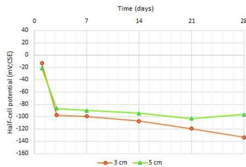
Gambar 4. Hasil pengujian half-cell potential pada tulangan tanpa cat ( non-coating )
