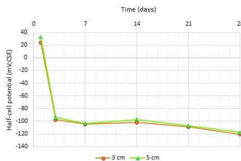
Gambar 5. Hasil pengujian half-cell potential pada tulangan dengan cat ( coating )
