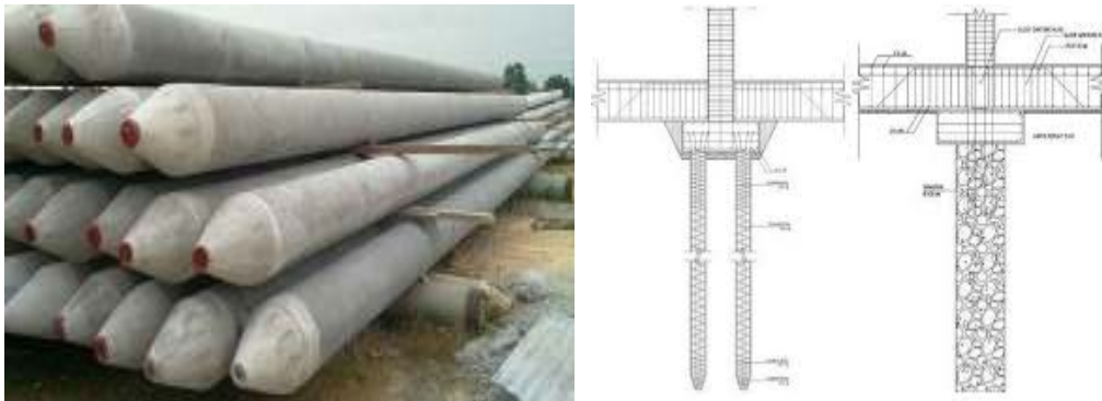
Gambar 7. Pondasi Tiang Pancang
