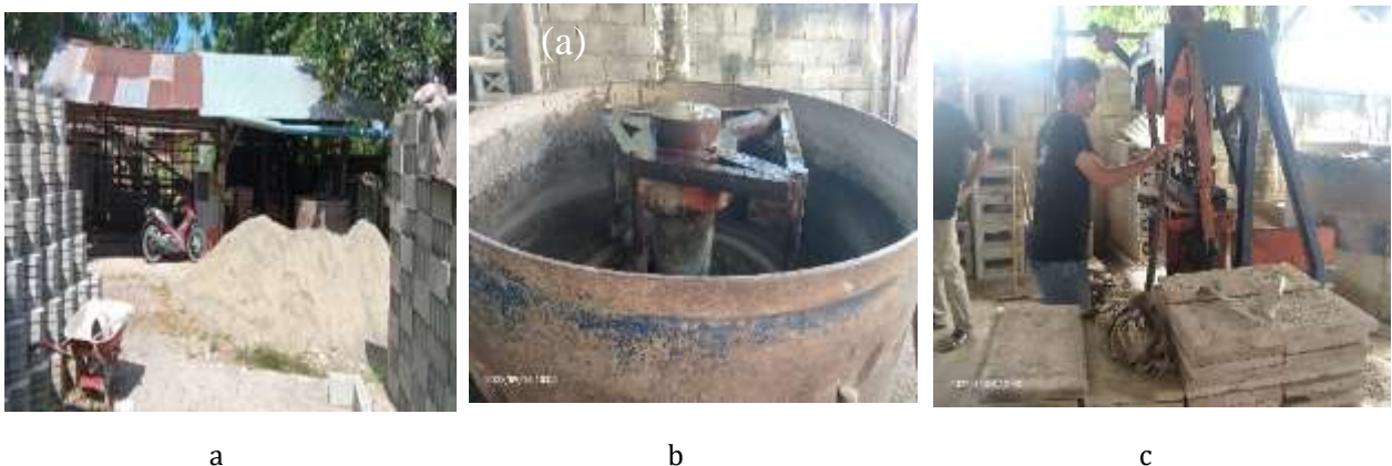
Gambar 2. Fasilitas yang dimiliki mitra, (a) lahan terbuka dan tempat pengeringan, (b) mesin pengaduk otomatis, (c) mesin press paving block
