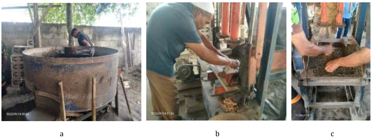
Gambar 4. Pembuatan paving block, (a) pengadukan dengan mesin, (b) pencetakan paving block dengan mesin pencetak.
