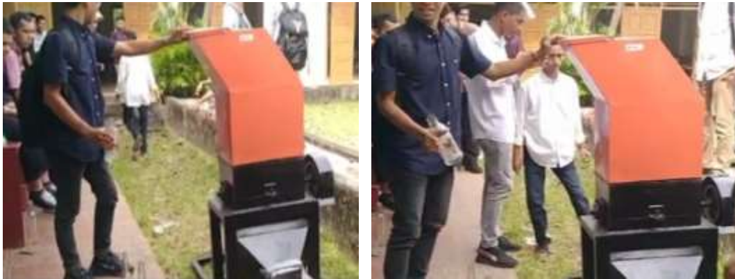
Gambar 3. Pendampingan cara menghancurkan kaca bekas menjadi pasir buatan
