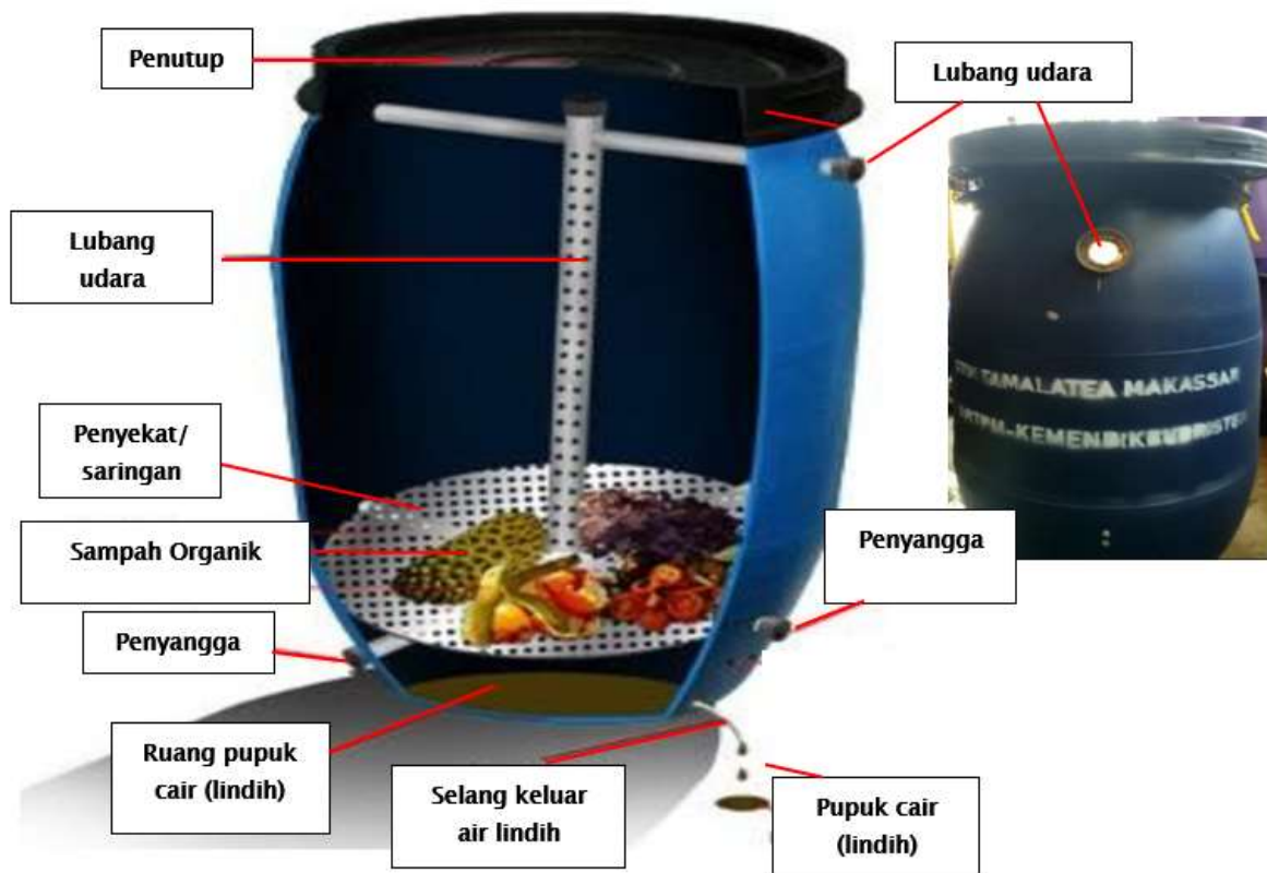
Gambar 1. Struktur Komposter Metode Aerob yang disampaikan kepada Mitra
