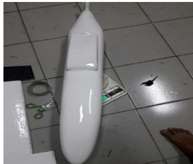
Gambar 2. Fuselage yang telah diberikan perlakuan finishing
