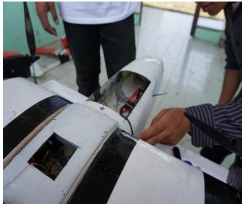
Gambar 4. Perakitan bagian wahana pesawat terbang tanpa awak serta installasi perangkat elektronik
