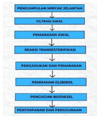
Gambar 3. Diagram Sistematis Proses Produksi Biodiesel
