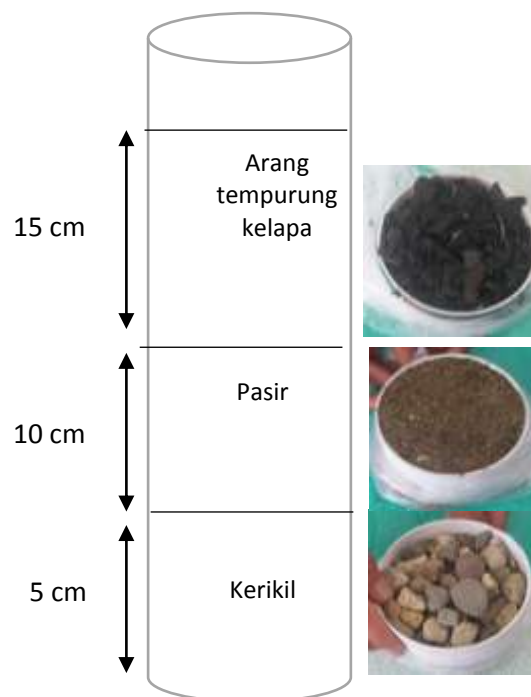
Gambar 13. Bahan penjernih air dan tinggi bahan dalam pipa PVC
