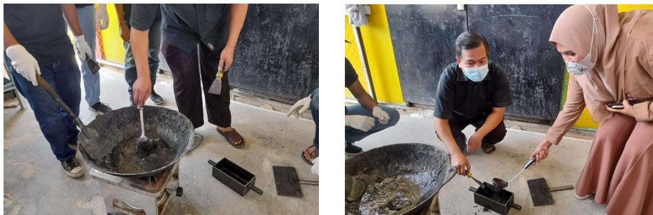
Gambar 2 Pembuatan *paving block* limbah plastik
