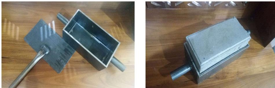
Gambar 3 Cetakan dan *paving block* limbah plastik
