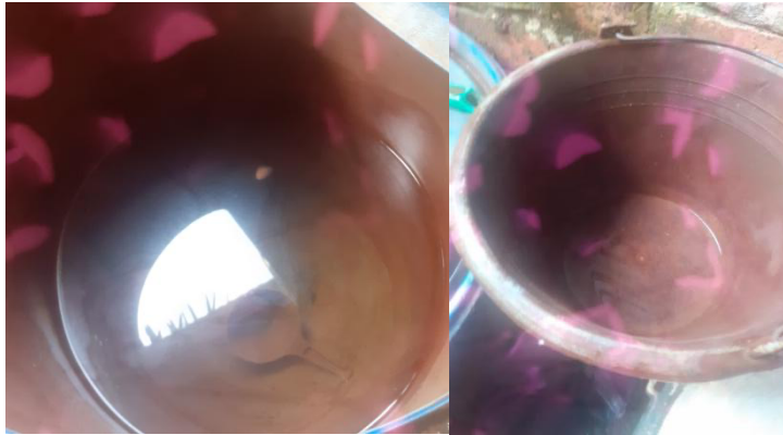
Gambar 1. Air sumur warga yang berwarna kekuningan dan berminyak (Kiri) dan ember tempat air yang meninggalkan karat berwarna kekuningan (Kanan)
