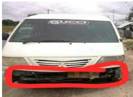
Keterangan: Kendaraan Bus milik PO Silvana yang tidak memenuhi syarat laik jalan dan tidak lulus uji berkala karena Bumper Depan Kendaraan tidak ada.
