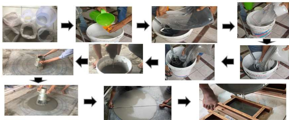
Gambar 2. Langkah-langkah pembuatan bata-ECC dan bata-CR ECC
