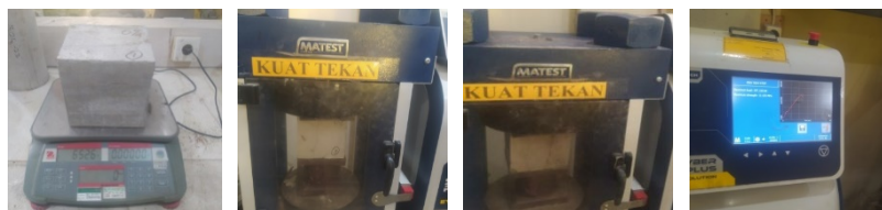
Gambar 3. Pengujian kuat tekan bata ringan CLC
