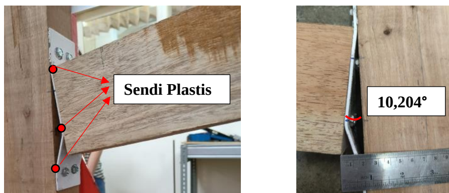
Gambar 5. Ragam kegagalan sambungan B-1, B-2, dan B-3
