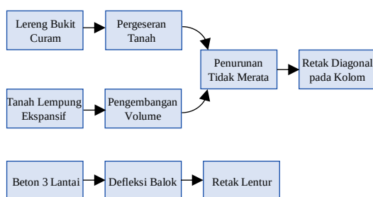
Gambar 4. Deteksi keretakan pada zona risiko tinggi
