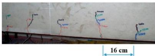
Gambar 11. Hasil eksperimental retak pada balok (Sumber: Ramos et al,2016)
