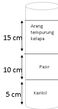
Gambar 16. Skema Material Alat Penjernih Air
