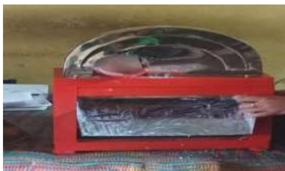
Gambar 5. Mesin Parut/Perajang/ Sawut Singkong
