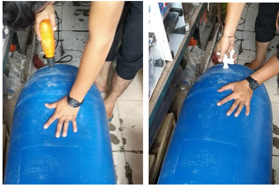
Gambar 9. Proses melubangi dan memasang kran
