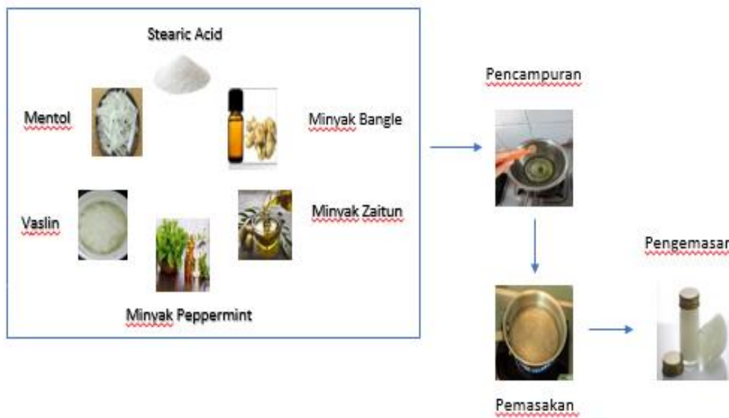
Gambar 3. Alur Pembuatan Bambang (Balsem Bangle) Hot
