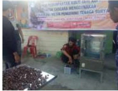
Gambar 10. Pengerian kulit kopi menjadi cascara menggunakan mesin pengering tenaga surya
