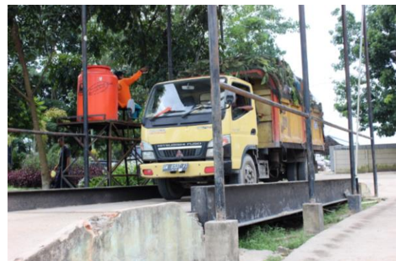
Gambar 3.3 Penyemprotan dan Penimbangan Setiap sampah yang Masuk Ke TPA
