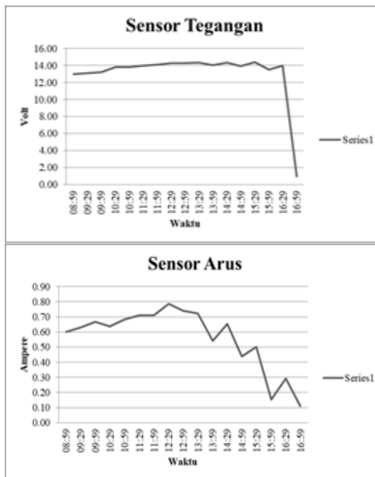
Gambar 6. Grafik Sensor Tegangan dan sensor arus terhadap waktu
