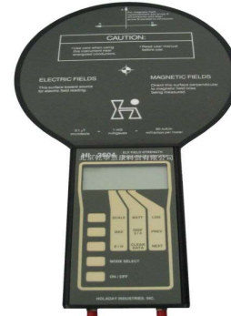
Gambar 9 Alat Ukur ETS-Lindgren (EMCO) HI-3604 ELF Survey Meter
