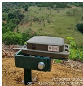
Gambar 3. (a) Alat Tiltmeter (b) Tiltmeter terpasang didekat rel [11]
