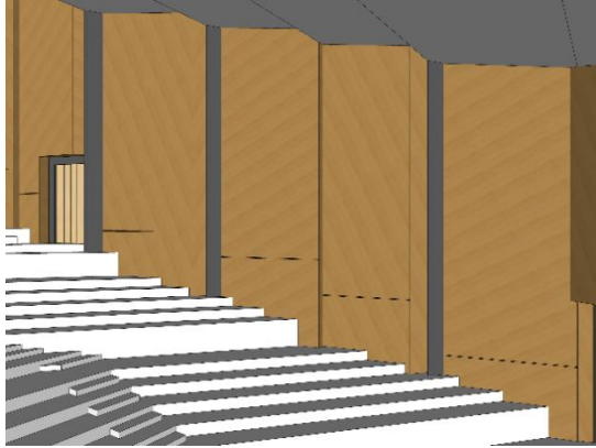
Gambar 12. Panel Dinding Pemantul Sumber : Penulis 2024
