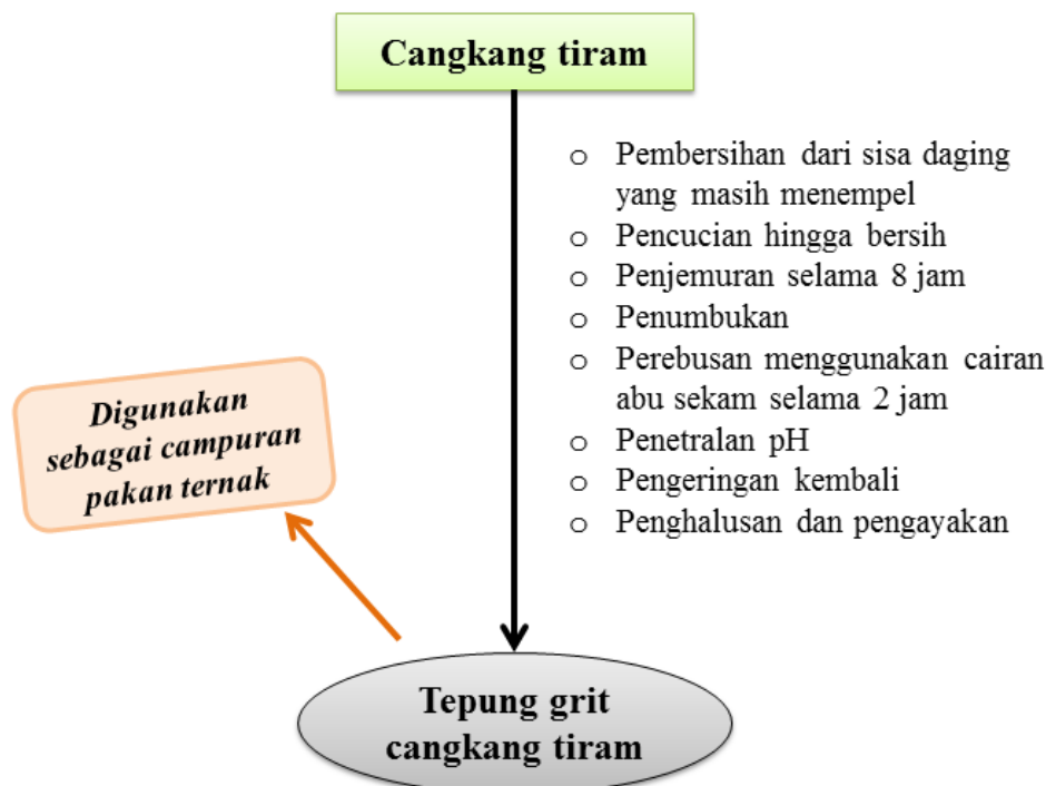
Gambar 2. Skema proses pembuatan tepung grit cangkang tiram sebagai campuran pakan ternak
