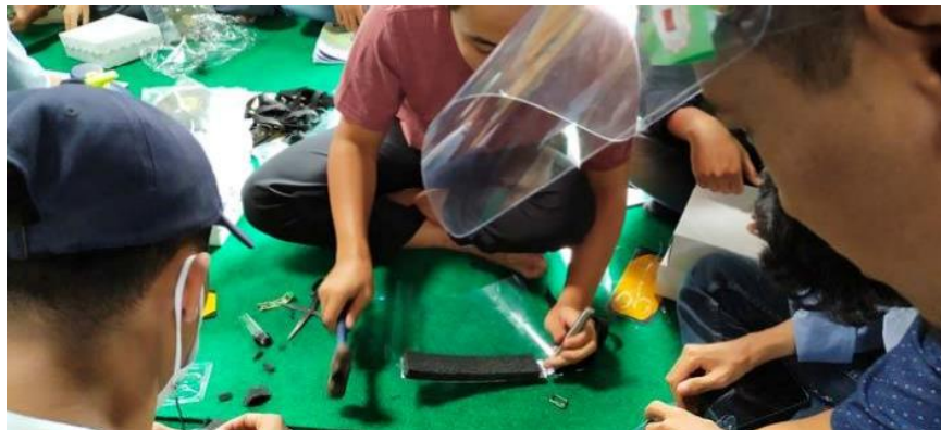
Gambar 10. Pengabungan antara bagian mika penutup face shield dengan mika buka tutup dengan menggunakan keling.
