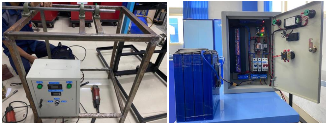
Gambar 4. Pengembangan dan realisasi mesin bubut berbasis PLTS
