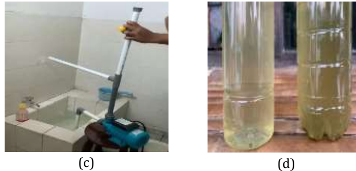
Gambar 7. Uji coba kemampuan sensor suhu dan pH (a) Uji coba solar panel (b) Uji coba pompa air (c) Hasil filter air menggunakan 4 bahan (d)
