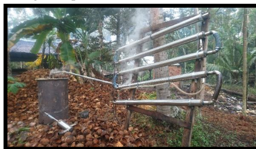
Gambar 2 Kondensor tabung paralel
