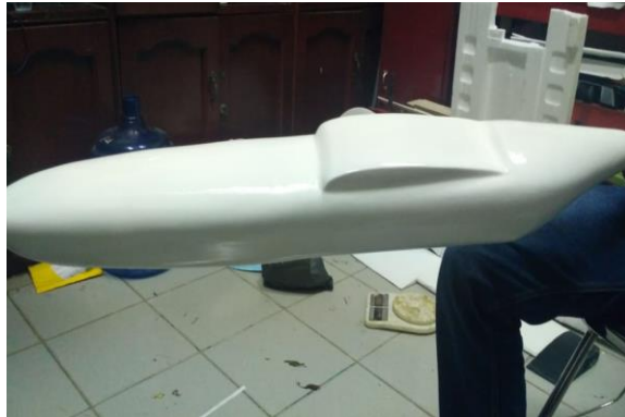
Gambar 3. Hasil akhir dari pembuatan badan pesawat terbang tanpa awak
