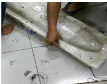
Gambar 2. Proses penyatuan kedua bagian badan pesawat terbang tanpa awak
