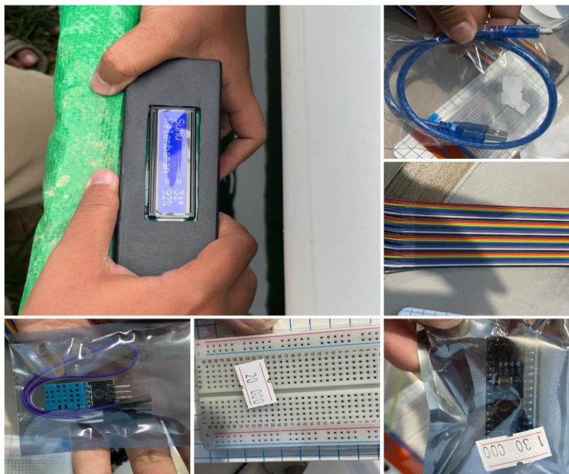
Gambar 4. Perancangan alat IoT berupa alat sensor DHT 11 dan Arduino.
