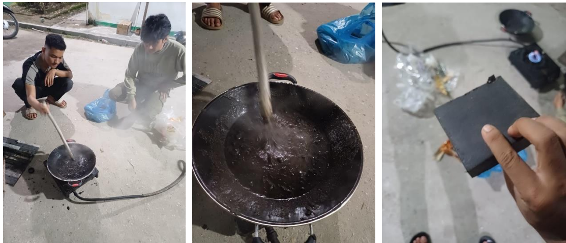
Gambar 2. Pengolahan Paving Block dari limbah plastik
