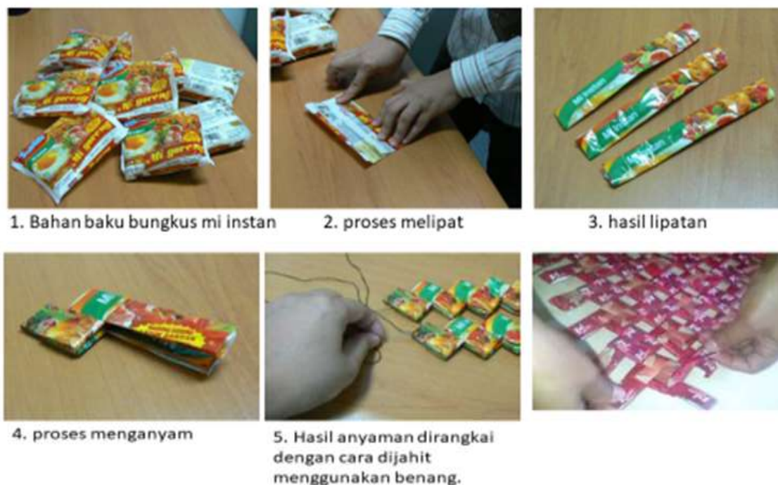
Gambar 2. Tahapan Pembuatan Tas Dari Sampah Plastik
