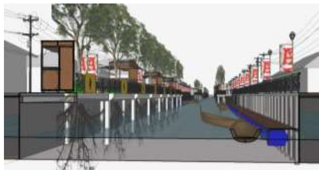
Gambar 16: Potongan konsep kantilever waterfront Segmen C di Kawasan Sungai Jawi Pontianak Sumber: Tim PKM Prodi Arsitektur Universitas Tanjungpura, 2018
