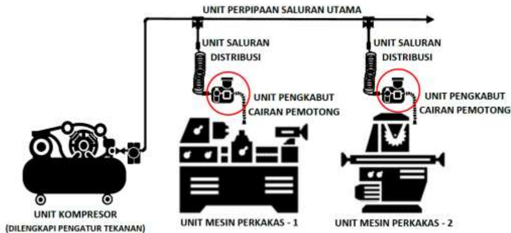
Gambar 2. Skematik rancangan instalasi sistem pendingin ramah lingkungan yang dibuat.
