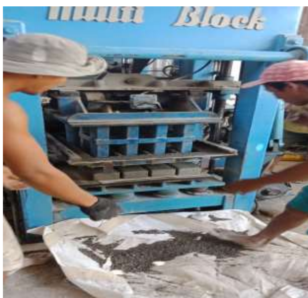
Gambar 2. Proses Pembuatan Paving Block
