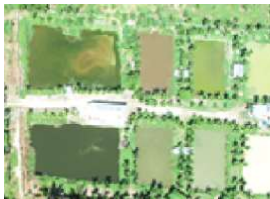
Gambar 5. Foto Udara UAV badan air di Kawasan Hutan Adat Ghimbo Pomuan Hasil penelitian Ikhwan, et. al. (2021) di kawasan Universitas Lancang Kuning, juga menjelaskan bahwa orthopoto tutupan lahan tubuh air berkarakteristik berwarna abu-abu, berona cerah, berbentuk geometri ke arah membulat dengan tekstur halus. Objek yang dimaksud adalah danau di Universitas Lancang Kuning.
