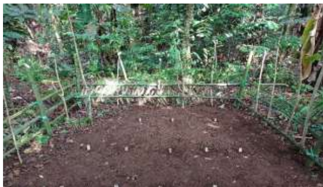
Gambar 2. Pengujian Keawetan Kayu
