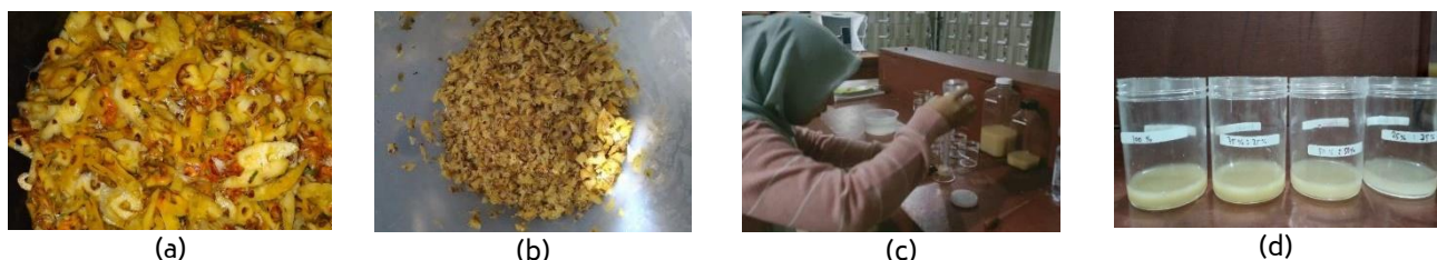
Gambar 2. Proses preparasi sampel, yang dimulai dari (a) limbah kulit nanas sebelum difermentasi, (b) limbah kulit nanas setelah fermentasi, (c) persiapan sampel, (d) sampel siap diuji
