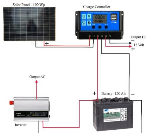
Gambar 2. Rangkaian Pembangkit Listrik Tenaga Surya (PLTS)
