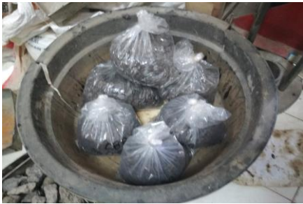
Gambar 3. Pemeraman Benda Uji
