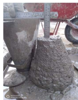
Gambar 2. Pengukuran slump beton
