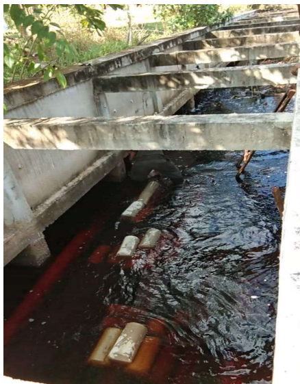
Gambar 4. Benda uji direndam dalam saluran air gambut.
