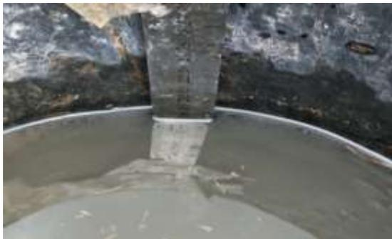
Gambar 5. Mengukur Parameter Infiltrasi di Lapangan
